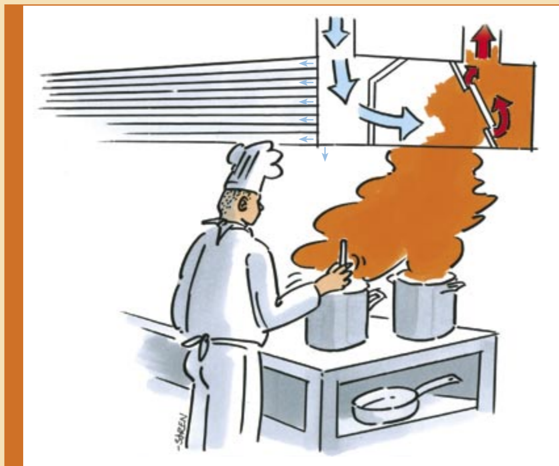
Skitse 2 viser emhætteudsugning med indfangningsstråle
